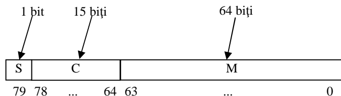
Figura 4.9. Formatele numerelor reale reprezentate în virgulă mobilă pentru coprocesorul Intel 8087, conform standardului IEEE 754.
