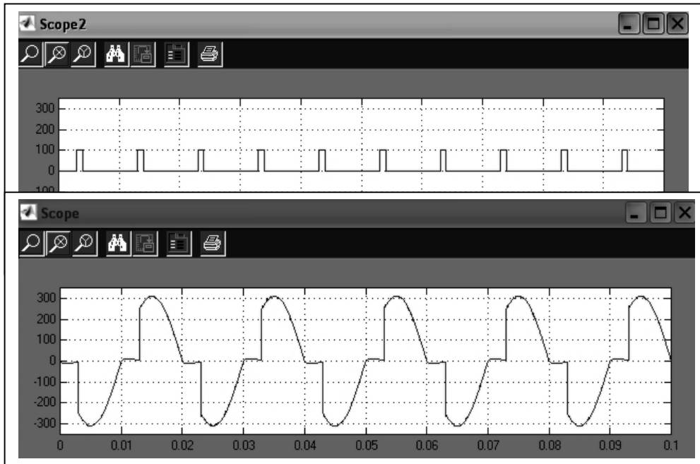
Figura 6.5: Impulsuri de amorsare (sus) și forma tensiunii pe sarcină (jos)
