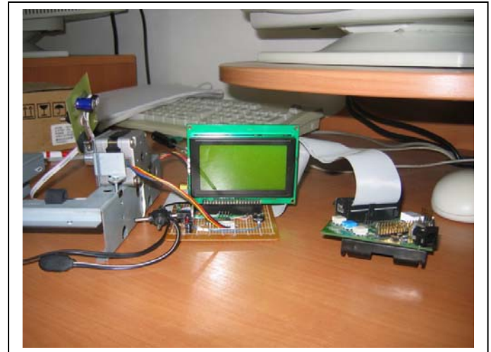
Figura 4. 48: Motorul pas cu pas și senzorul (stânga) și o fotografie a sistemului de test (dreapta)
