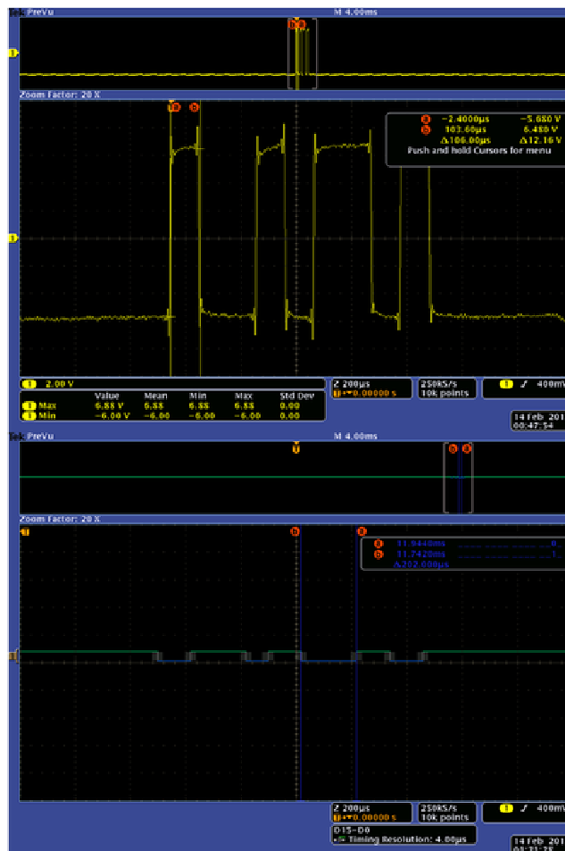
Figura 5.16. Diagrama transferului serial RS232 a unui caracter (jos la nivel TTL, sus la nivel RS232)
