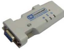
Figura 10.8. Adaptorul Bluetooth serial LM058 (sursa www.farnell.ro )
