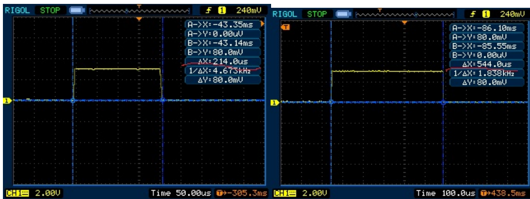
Figura 2.11. Comparație între transferul DMA și programat (sursa: http://www.embedds.com/using-direct-memory-access-dma-in-stm23-projects/ )
