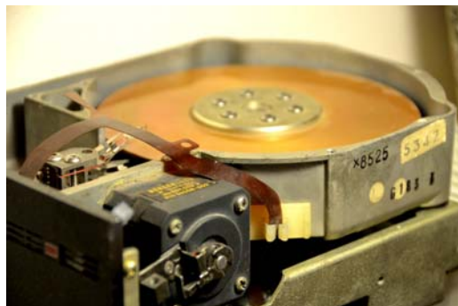
Figura 12.1. Hard disc Seagate de 5,25" de 20M (sursa: colecția personală P. Ogruțan)
