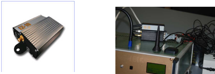
Figura 7.1. Modulul GPRS Telit EZ10 (stânga) și un aparat conectat prin GPRS (dreapta)
