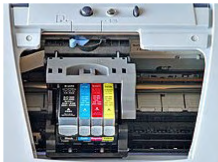
Figura 7.17. Rezervoare de cerneală, sursa https://en.wikipedia.org/wiki/Inkjet_printing
