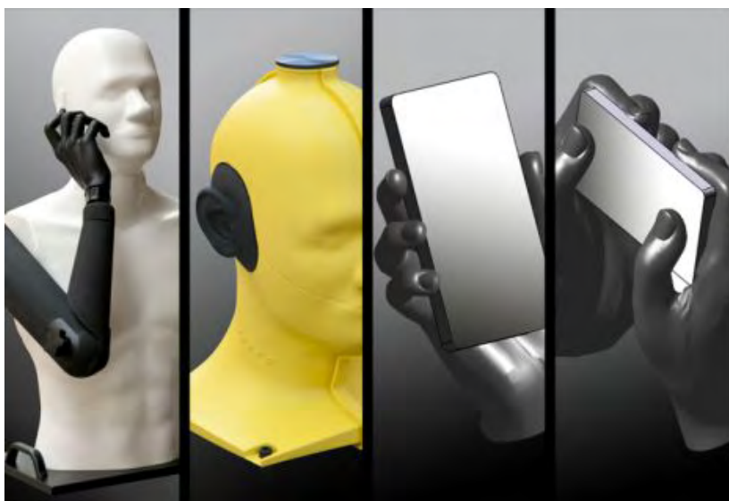
Figura 13.5. Forme umane utilizate în măsurarea SAR, sursa http://www.speag.com/news-events/news/measurement/new-phantom-products/
