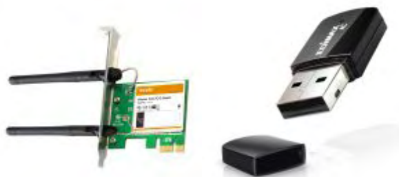
Figura 5.9. Adaptor wireless PCIe (stânga) și adaptor wireless USB (dreapta), sursa http://www.emag.ro/adaptoare_ethernet/c
