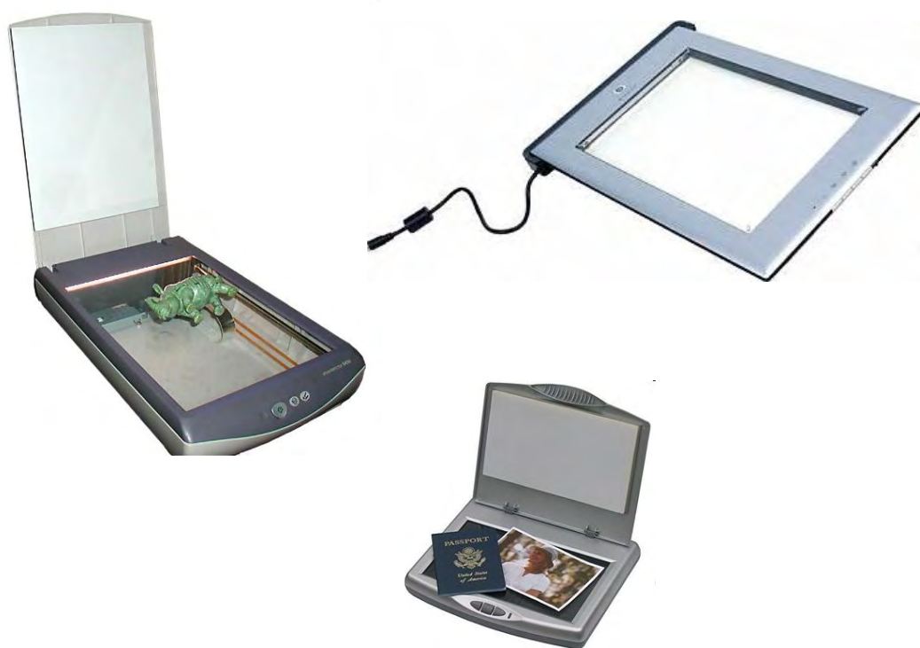
Figura 8.13. Scanner flatbed (stânga), sursa https://en.wikipedia.org/wiki/Image_scanner și scannerul transparent HP (dreapta), sursa http://www.tomshardware.com/reviews/high,781-11.html și un scanner de acte de identitate (jos), sursa http://www.amazon.com/Scanshell-Portable-Compact-Flatbed-Passport/dp/B000GZBRRE
