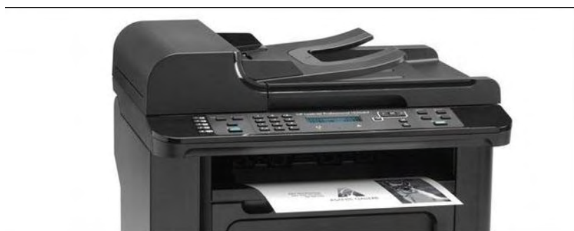
Figura 8.14. Multifuncțională cu scanner și ADF, sursa http://www.howtogeek.com/102092/buying-guide-printers/
