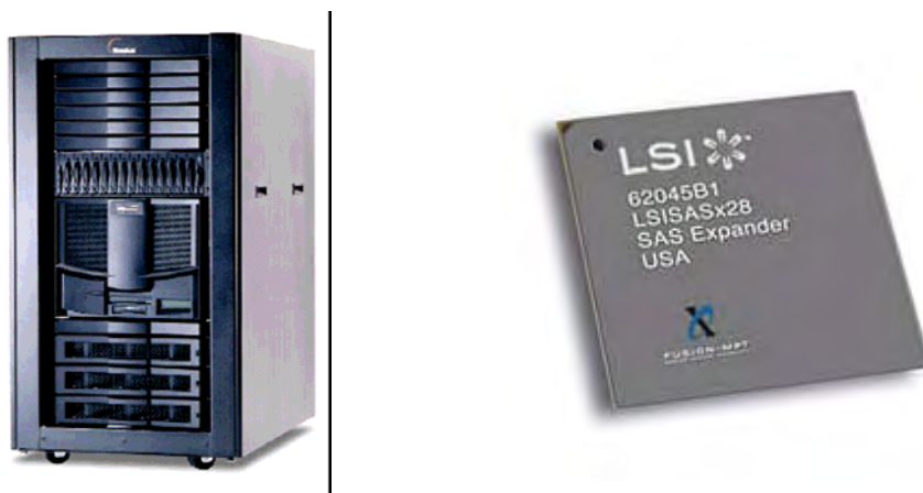
Figura 11.7. Serverul Stratus® ftServer® 6500 System sursa http://www.stratus.com/assets/5200hw.pdf și circuitul LSI LSISASx28, sursa http://docs.avagotech.com/docs/12352182
