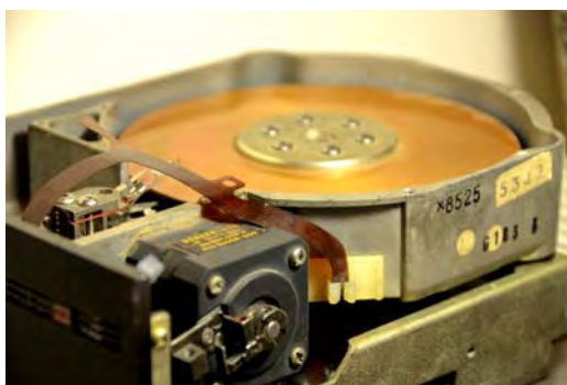
Figura 3.1. Hard disc Seagate de 5,25” de 20M (sursa: colecția personală P. Ogruțan)
