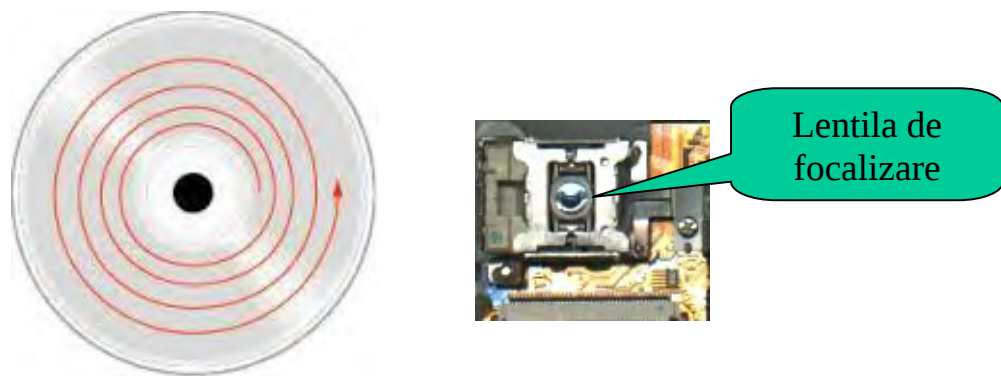
Figura 3.12. Aranjarea spirală a datelor pe disc (stânga), sursa http://www.hkadesigns.co.uk/websites/msc/foun/index.htm și un cap de scriere / citire (dreapta)
