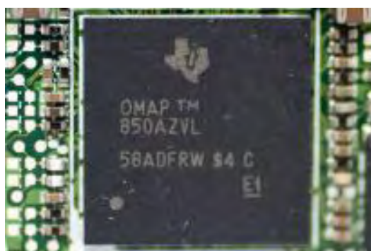
Figura 10.21. Circuit din familia OMAP într-un telefon HTC, sursa https://en.wikipedia.org/wiki/OMAP
