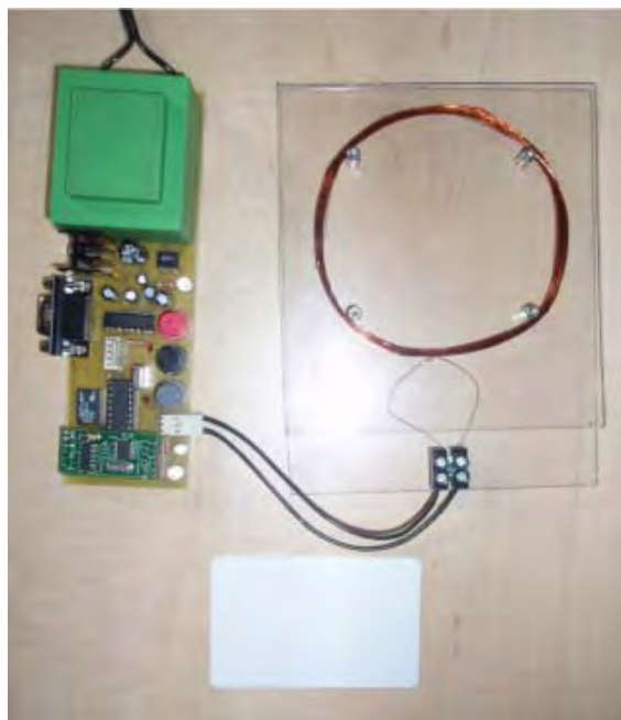
Figura 5.18. Sistem RFID cu microcontroller
