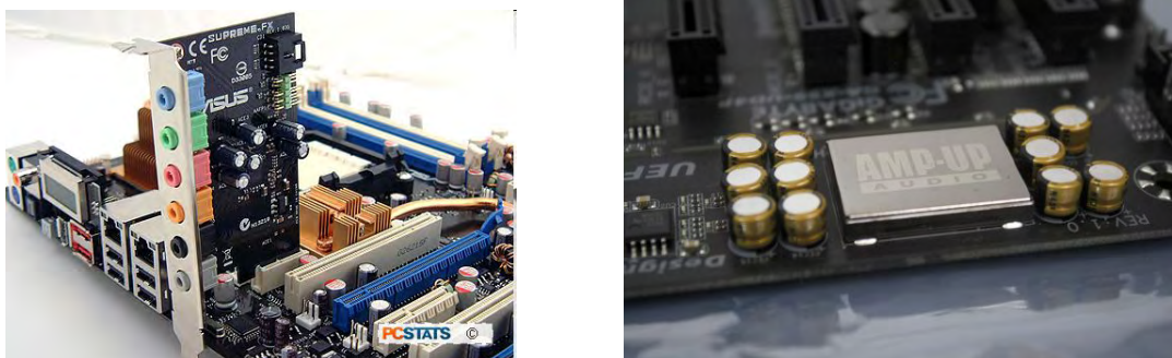
Figura 9.2. Placă de sunet conectată pe magistrala PCIe (stânga), sursa http://www.pcstats.com/articleview.cfm?articleid=2077&page=5 și un circuit de sunet pe placa de bază a unui PC, (dreapta), sursa http://www.bjorn3d.com/2015/05/gigabyte-x99-ud4p/3/
