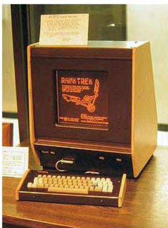
Figura 6.7. Primul monitor cu plasmă, sursa: https://en.wikipedia.org/wiki/Plasma_display
