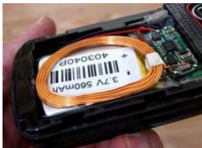
Figura 10.10.Încărcarea inductivă, principiu (sus), sursa https://en.wikipedia.org/wiki/Wireless_power și o bobină de transfer din interiorul unui telefon, sursa http://blog.dx.com/charge-your-cell-phone-with-diy-wireless-charging-module/
