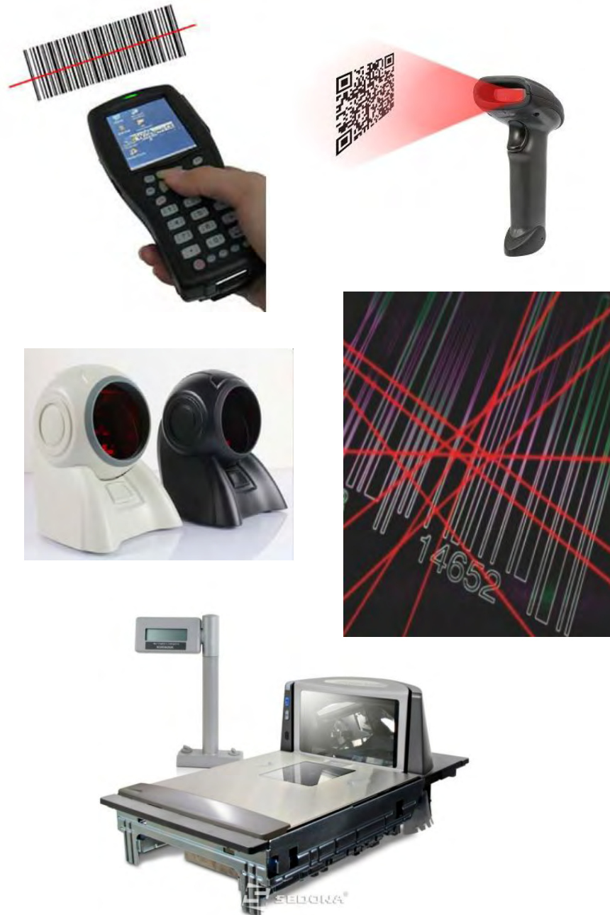
Figura 8.23. Scannere de coduri de bare sub forma unui dispozitiv multifuncțional (stânga sus), sursa http://www.quickembed.com/Tools/Shop/POS/201005/110.html , sub forma unui dispozitiv de mână (dreapta sus), sursa http://cplonline.com.au/pos-systems/barcode-scanners/2d-handheld-barcode-scanner-xl-3100.html și dispozitive omnidirecționale (mijloc) și imaginea razelor care baleiază codul, sursa http://www.alibaba.com/product-detail/new-pos-barcode-scanner-FG2038-Handfree_1804870978.html . Scanner integrat în masă cu cântar pentru magazine (jos), sursa http://www.aparaturafiscala.ro/ro/cititoare-coduri-de-bare-fixe/12431-scanner-de-masa-cu-cantar-datalogic-magellan-8300.html
