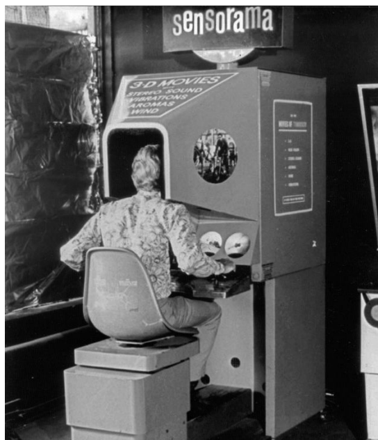
Figura 9.6. Sensorama, primul dispozitiv care permitea proiectarea de imagini cu sunet, miros și atingere, sursa http://www.engadget.com/2014/02/16/morton-heiligs-sensorama-simulator/
