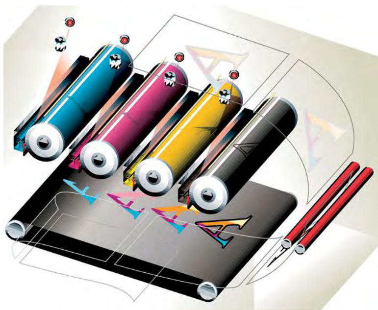
Figura 7.12. Principiul imprimării electrofotografice color, sursa http://polystation.pl/uwaga-nowa-usluga-regeneracja-tonerow-do-drukarek-laserowych/drukowanie-od-a-do-z-drukarki-laserowe-5/
