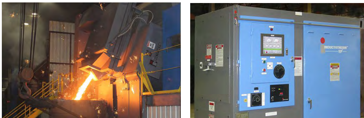
Figura 12.6. Cuptor cu inducție (stânga) și calculatorul de proces (dreapta), sursa http://ondarlan.com/blog/product_categories/inductotherm/?lang=en
