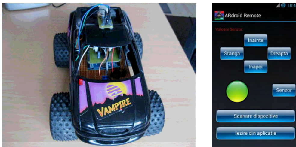
Figura 2.20 . Sistem mobil pentru verificarea concentrației de gaz construit în cadrul unui proiect de diplomă
