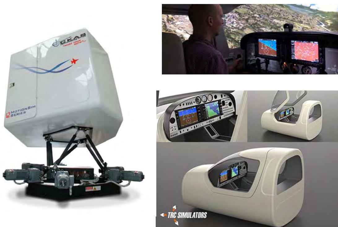
Figura 9.7. Simulatoare de zbor, în stânga cel produs de CKAS Mechatronics, sursa http://www.ckas.com.au/flight_simulators_27.html și unul simplu produs de TRC Simulators, sursa http://www.trcsimulators.com/trc-simulators-cabins/
