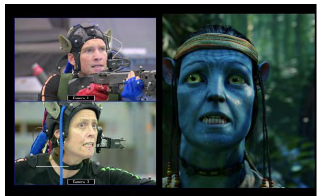
Figura 9.14. Compunerea unei imagini animate prin urmărirea mișcării unei persoane acoperită cu senzori. Sistemul de măsurare asigură o rezoluție de 3600x3600 la 480Hz asigurând o înregistrare în timp real și cu precizie milimetrică a mișcării, sursa https://en.wikipedia.org/wiki/Motion_capture (stânga) și urmărirea mișcării corpului în filmul Avatar, sursa http://www.cgchannel.com/2012/01/interview-avatar-mocap-producer-james-knight/
