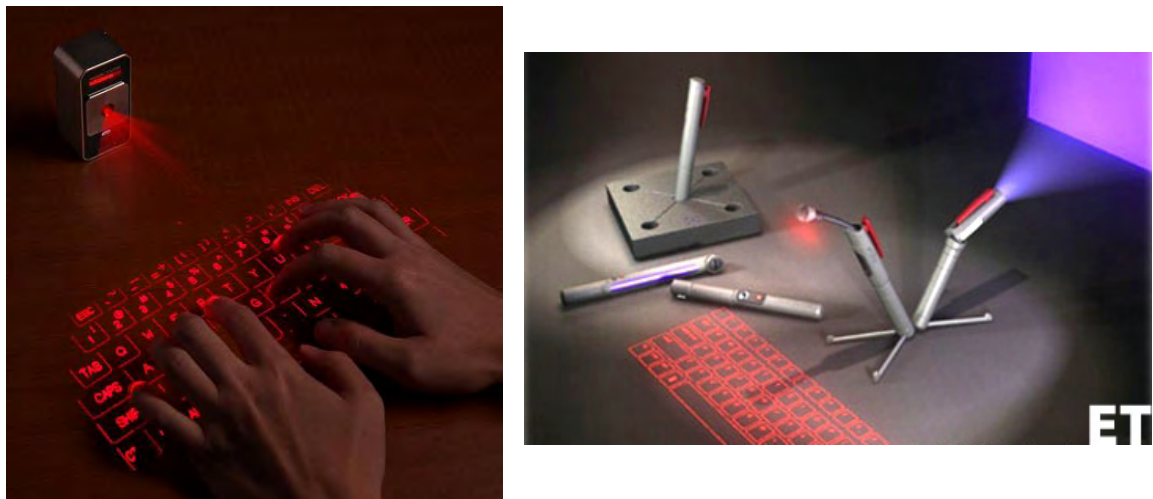
Figura 9.9. Tastatura virtuală (stânga), sursa http://wordlesstech.com/cube-laser-virtual-keyboard/ și un calculator cu imagine și tastatură proiectată, (dreapta), sursa http://blogextremetec.blogspot.ro/2006/04/extreme-networking-pen.html
