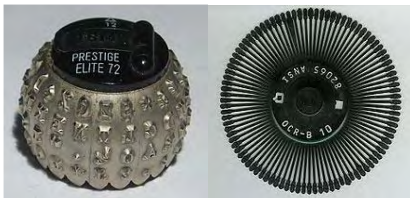
Figura 7.1. Bilă cu caractere (stânga) și margaretă (dreapta), sursa https://en.wikipedia.org/wiki/Printer_(computing)
