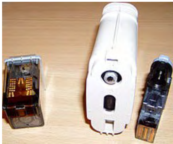
Figura 7.16. Capete de imprimare cu cerneală, sursa https://en.wikipedia.org/wiki/Inkjet_printing
