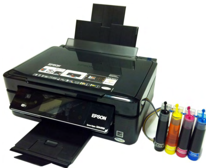
Figura 7.18. Sistemul de alimentare continuă cu cerneală, sursa
