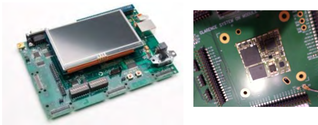
Figura 10.25. Modul de dezvoltare OMAP L-138, (stânga), sursa http://www.logicpd.com/products/system-on-modules/zoom-omap-l138-experimenter-kit/ și un sistem de dezvoltare pentru Qualcomm Snapdragon (dreapta) care conține procesorul, memorie DDR și Flash, sursa http://linuxgizmos.com/sneak-peek-at-a-proof-of-concept-snapdragon-mcm/
