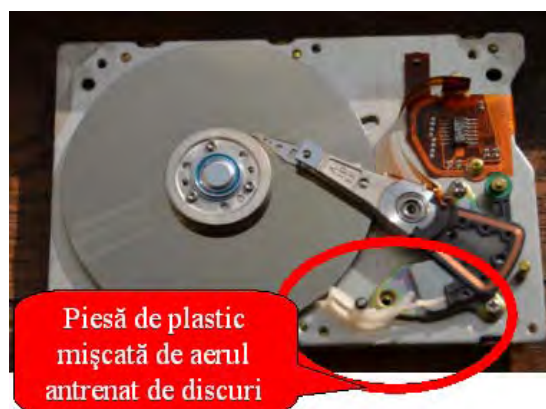
Figura 3.5 Sistem de parcare a capetelor cu o piesă care blochează capetele când discurile nu se rotesc, sursa colecția Petre Ogruțan
