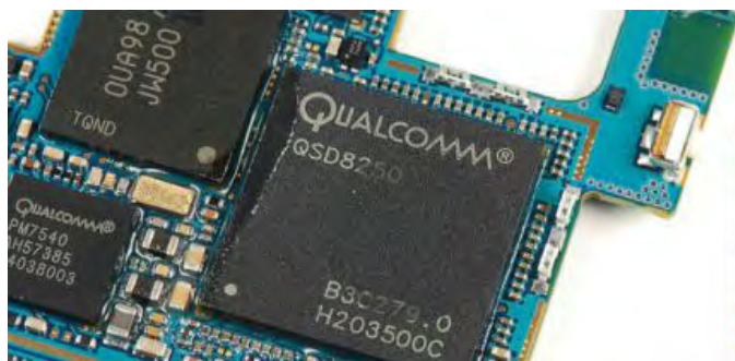
Figura 10.20. Circuit Qualcomm pe o placă electronică de telefon, sursa http://www.rcrwireless.com/20150126/chips/qualcomm-chipsets-power-smartphones-2014
