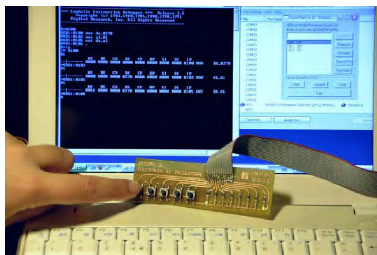
Figura 2.22. Dispozitivul cu LED-uri conectat la o interfață paralelă de PC
