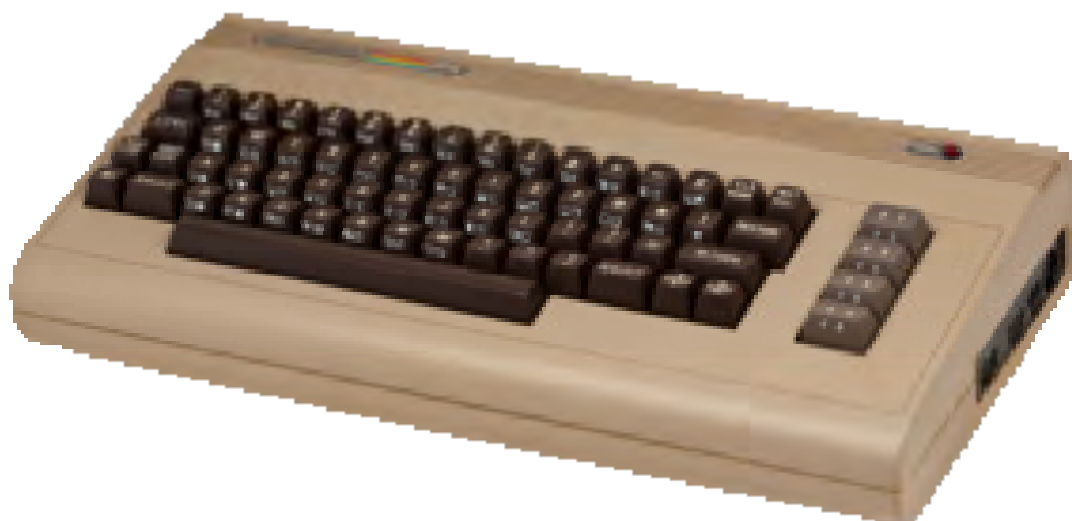
Figura 1.13 Calculatorul Commodore 64 (1982), cu procesor pe 8 biți, 64Kocteți RAM, deține recordul de vânzări în SUA între anii 1983-1986. Sursa http://en.wikipedia.org/wiki/Commodore_64
