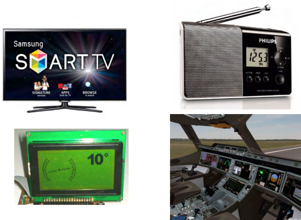
Figura 6.5. TV LCD, radioreceptor portabil cu afișaj LCD, , un afișaj LCD grafic utilizat la un proiect condus de autor pentru măsurarea înclinăției, cabina avionului AIRBUS A350 prevăzută cu afișaje LCD
