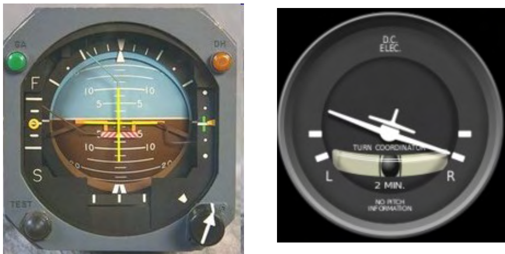
Figura 9.18. Indicatoare de înclinăție pentru avioane, sursa https://en.wikipedia.org/wiki/Attitude_indicator , http://cfi-wiki.net/w/Gyroscopic_Instruments
