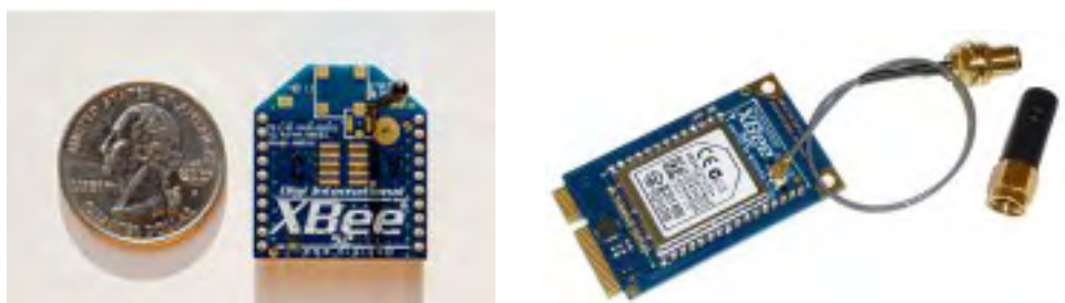
Figura 5.16. Modul Xbee (stânga), sursa https://en.wikipedia.org/wiki/XBee și modul ZigBee cu interfață PCIe (dreapta), sursa http://www.whitebream.com/xbee
