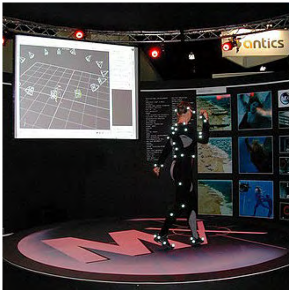
Figura 9.13. Sisteme optice de înregistrare pentru urmărirea mișcării corpului. O dansatoare cu un costum cu senzori reflectivi (stânga) și senzori aplicați pentru urmărirea expresiei faciale (dreapta).sursa
