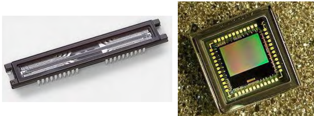
Figura 8.15. Senzorul liniar pentru scanner (stânga), sursa http://www.betterlight.com/how_they_work.html și senzorul matricial al aparatului foto digital (dreapta), sursa https://en.wikipedia.org/wiki/Active_pixel_sensor
