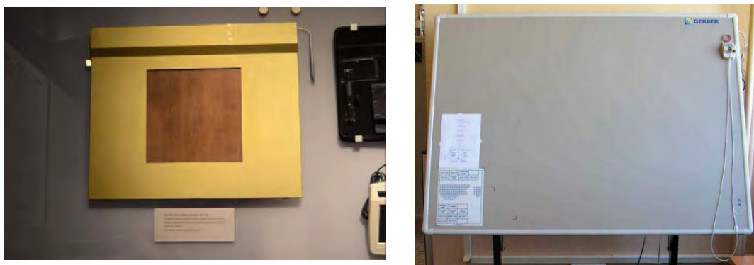
Figura 8.6. Tableta RAND (stânga, sursa RAND Tablet from Computer History Museum by Brian Hicks, Nov. 3rd, 2013) și o tabletă de mari dimensiuni, cu un puc în dreapta sus (sursa https://en.wikipedia.org/wiki/Graphics_tablet )
