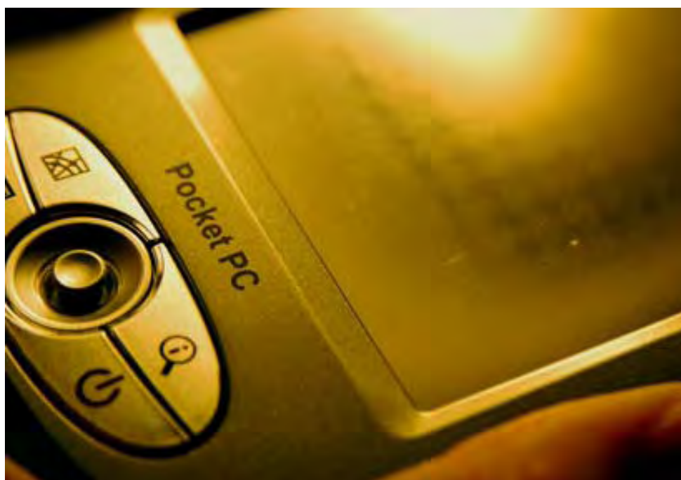
Figura 8.4. Suprafața activă la un ecran sensibil pe principiul PCT (foto autorul)
